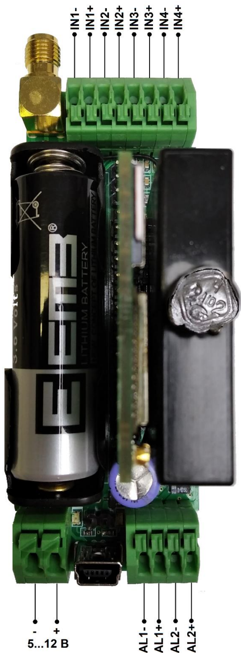
Рис. А2.1. Обозначение клемм ЛЭРС СИ-4 NB-IoT
