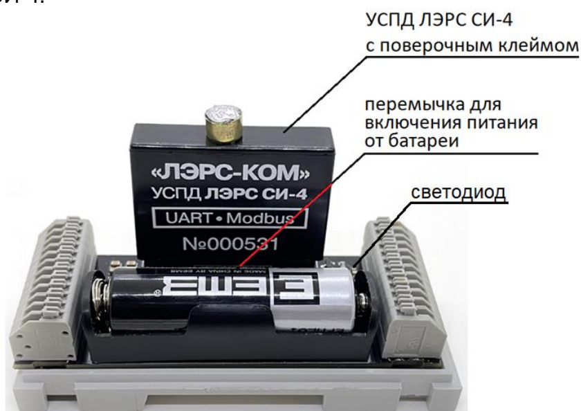
Рис. 1. Внешний вид счётчика импульсов ЛЭРС СИ-4 RS-232/485 со снятым корпусом
