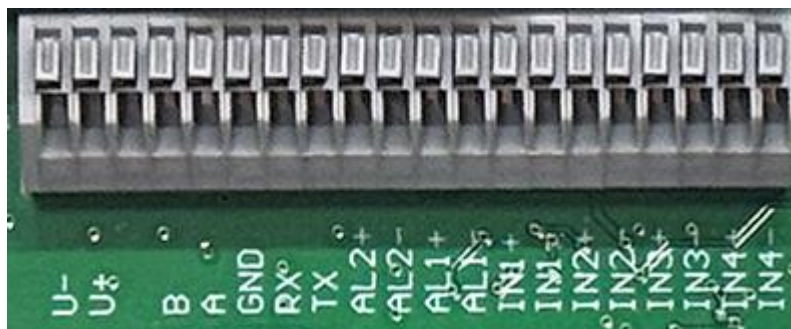
Рис. А2.1. Обозначение клемм ЛЭРС СИ-4 IP65
