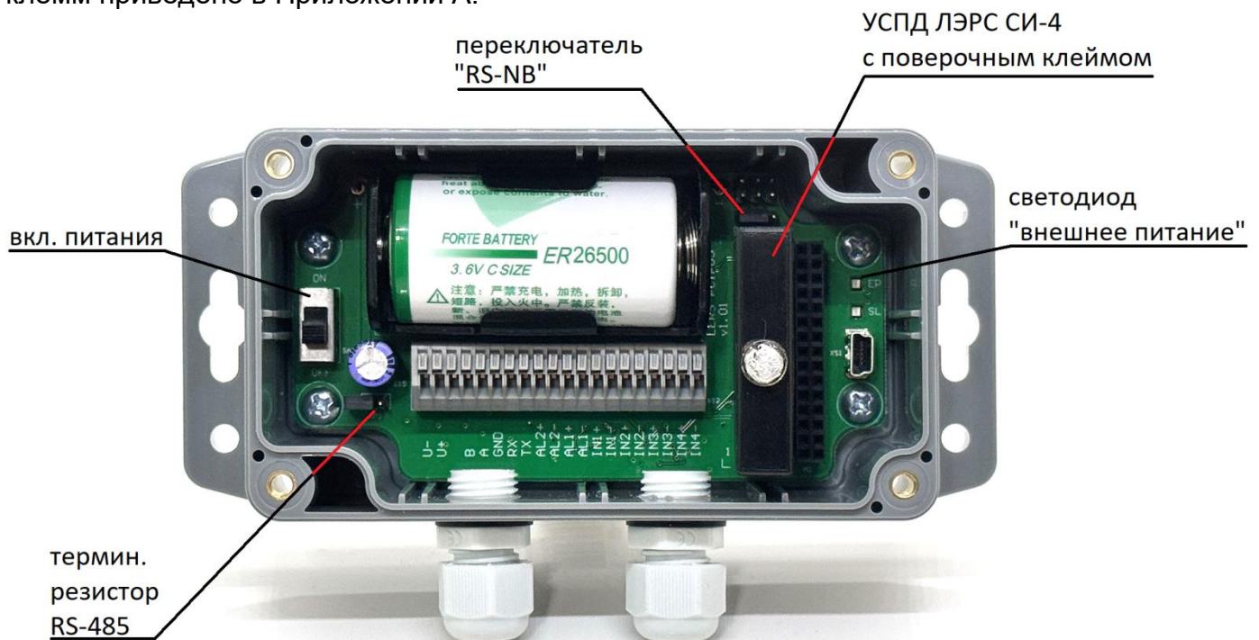
Рис. 2. Внешний вид счётчика импульсов ЛЭРС СИ-4 RS-232/485 IP65 со снятой крышкой
